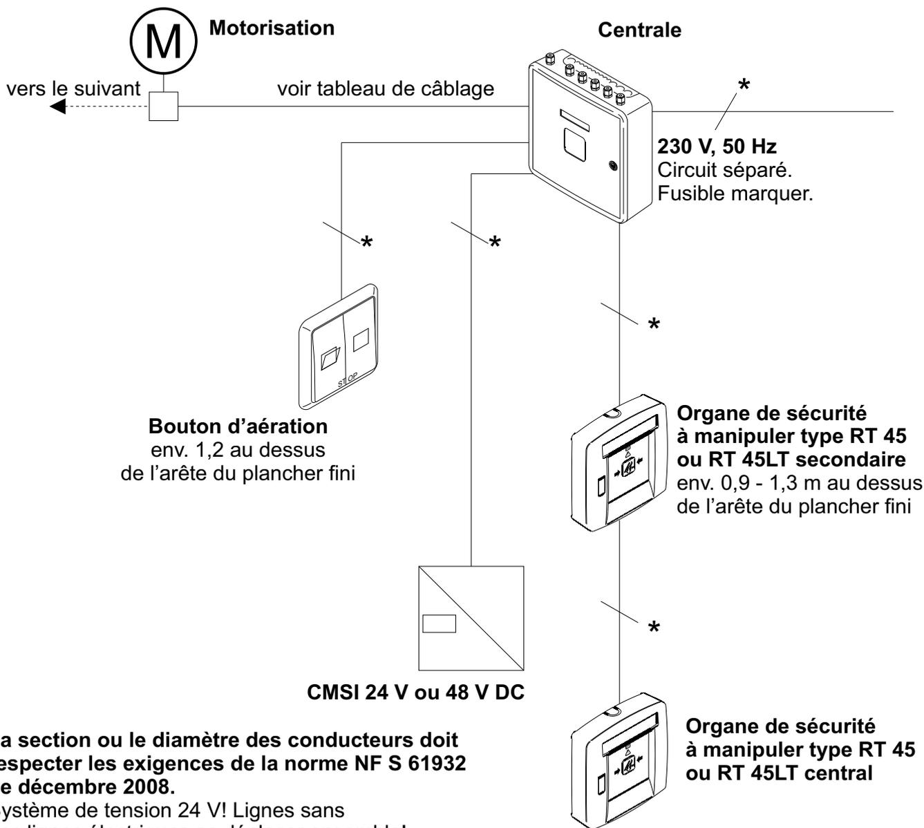
\* La section ou le diamètre des conducteurs doit respecter les exigences de la norme NF S 61932 de décembre 2008.
